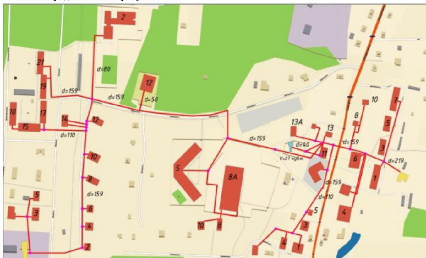
Рисунок 1.2 – Зона действия централизованного теплоснабжения котельной
